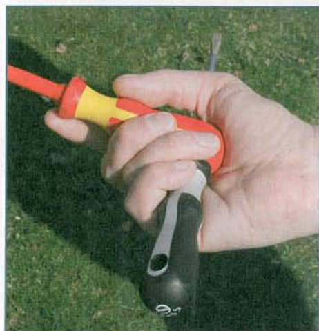
Wenn eine Schraube einmal festsitzt, kann durch das Loch im Griff ein „Knebel“ gesteckt werden, um das Drehmoment zu erhöhen
