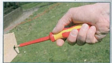
Ein sicherer Sitz des Schraubendrehers in der Schraube stellt sicher, dass die Schraubenköpfe nicht beschädigt werden
